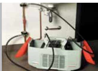
Цилиндрическая замораживающая головка для быстрой смены переходников.
